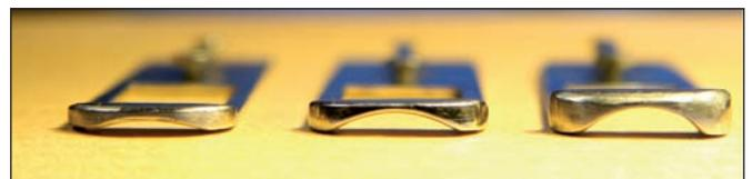
Fig. 4. Guías con diferente profundidad de corte.
