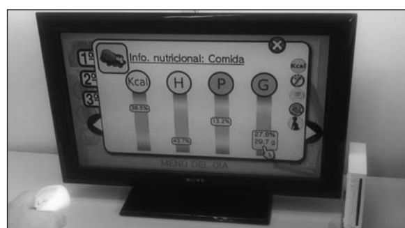
Fig. 6.—Asistente nutricional inteligente desarrollado para la gestión de los menús de las escuelas infantiles. Interfaz de usuario para la consola Nintendo Wii mostrando la información nutricional básica del menú escolar de un niño calculada de forma automática a partir de sus ingredientes.
