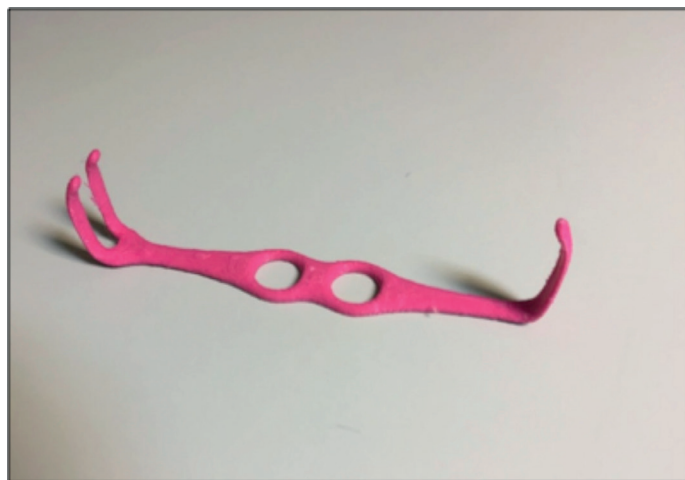
Figura 2. Impresión en PLA de separador tipo Mathieu, listo para ser usado.
