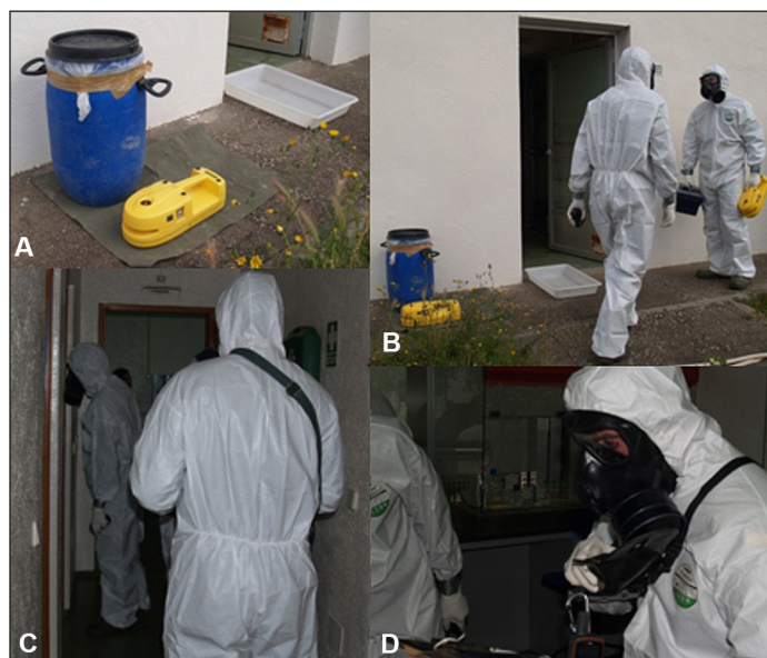
Figura 4. A. Contenedor de residuos, equipo de muestreo de aerosoles Biocapture™ y bandeja para descontaminación. B. Entrada del equipo RECO al escenario. C. Reconocimiento de las salas. D. Transferencia de información al punto de control.
