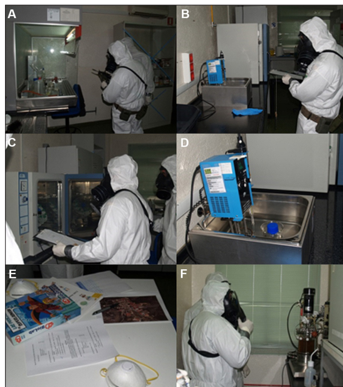
Figura 5. A. Cabina de seguridad biológica. B. Zona de trabajo con estufa y baño termostatzado. C. Interior de estufa de cultivo. D. Interior del baño termostatzado. E. Documentación encontrada en una de las salas. F. Fermentador.
