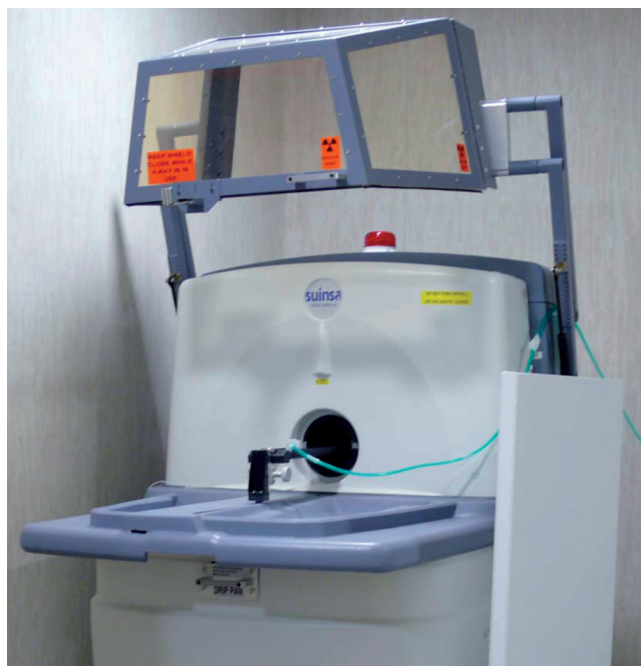
Figura 2 – Equipo de tomografía por emisión de positrones y tomografía computarizada para pequeños animales de laboratorio.
