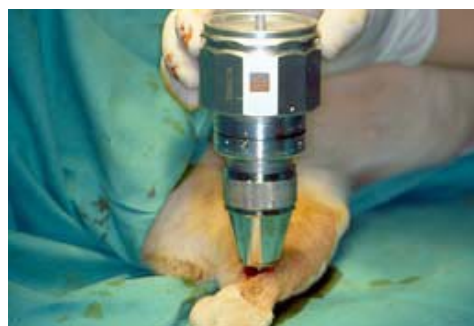
Fig. 1. Extracción de implantes de la región tibial de los animales mediante la colocación del calibrador de torque Tonichi.
