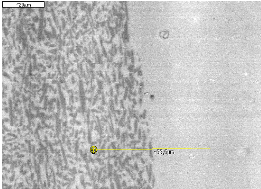
Fig. 1. Muestra IPS-Empress 2 a 1000 X 1: Núcleo o cofia interna. 2: Interfase. 3: Cerámica de recubrimiento
