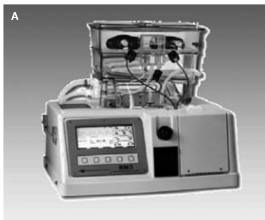
Figura 5 Dos modelos diferentes de máquinas de perfusión continua y flujo pulsátil para preservación renal. A: modelo Waters RM3 ® Renal Preservation System de Waters Medical System ® . B: modelo Life Port Kidney Transporter ® de Organ-Recovery Systems ® .
