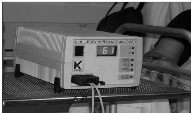
Figura 1: Monitor de bioimpedancia
