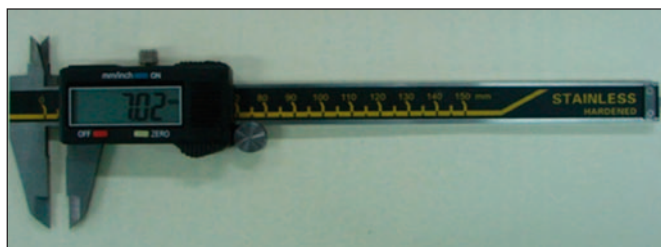
Fig. 2. Calibrador digital usado para medir el espacio entre el tope y el descanso del diente.
