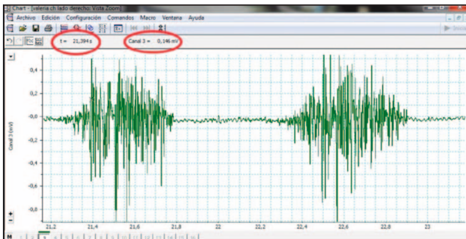
Fig. 3. Análisis de tiempo (segundos) y amplitud (milivolts) del golpe masticatorio con la herramienta vista zoom del software Chart 5 para Windows.
