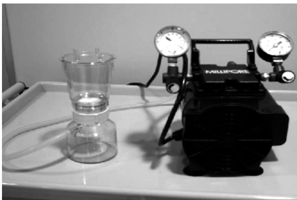
Imagen 1. Set de filtración y bomba de vacío utilizadas para control microbiológico de nutrición parenteral utilizado en método de filtración (adaptado Montejo y cols.)
