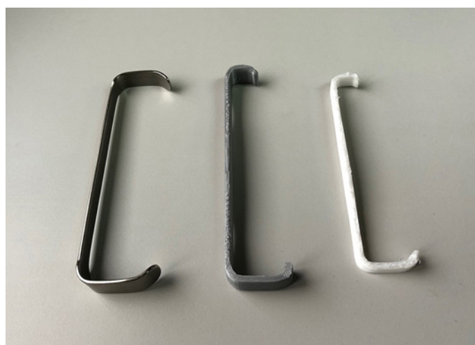
Figura 2. De izquierda a derecha, distintos separadores tipo Farabeuf en acero quirúrgico, en ABS y en PLA.
