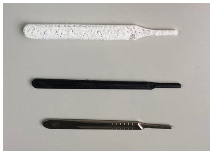
Figura 1. De izquierda a derecha, distintos mangos de bisturí en PLA, en ABS y en acero quirúrgico.
