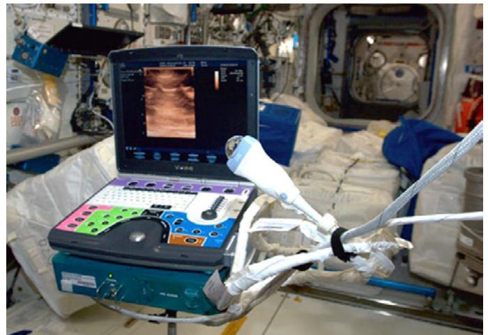
Figura 1. Sistema Ultrasound II (Vivid Q, General Electric, EE.UU.). El teclado de colores permite una orientación remota del dispositivo. Se emplea agua en lugar de gel de ultrasonido debido al cambio en la tensión superficial en ingravidez. Cortesía de la NASA
