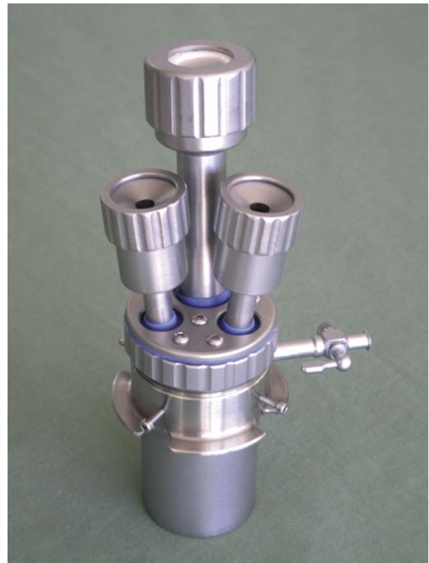
FIGURA 2. Foto de la cánula donde se ha cambiado la tapa de 5 cinco orificios por otra que tiene dos orificios de cinco y uno de doce milímetros con sus correspondientes válvulas.
