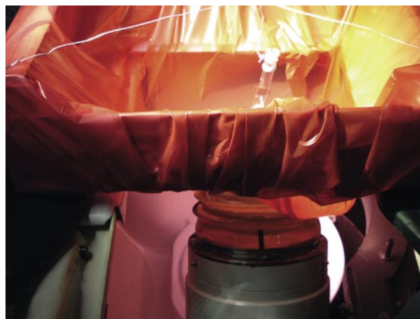
FIGURA 2. Cono neumático haciendo contacto con el dispositivo.
